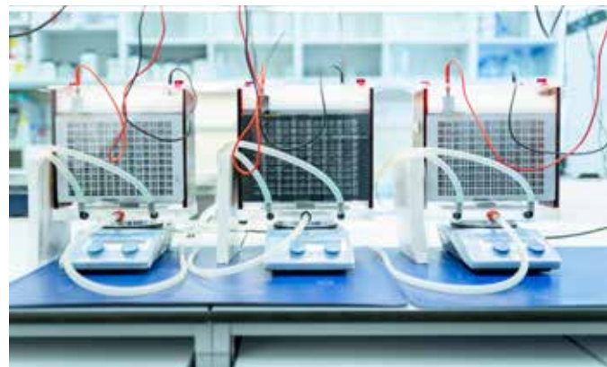
3 Blotkammern (Amersham Biosciences) für das Western Blotting der von Willebrand Faktor Multimere
