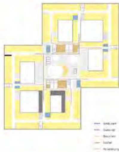
Alternative Bettenstellung durch versetzte Nasszellen
